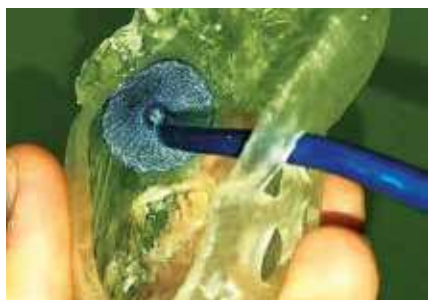
Model části srdce pacienta vytisknutý na 3D tiskárně a zkouška okluderu
